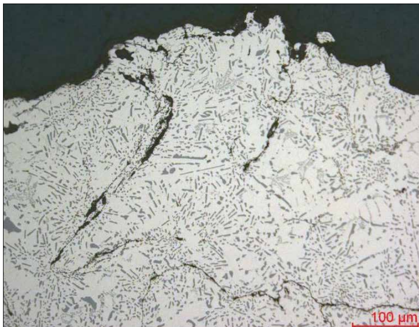
Bild 6: Oxidhaut in einem Aluminiumgussstück.
