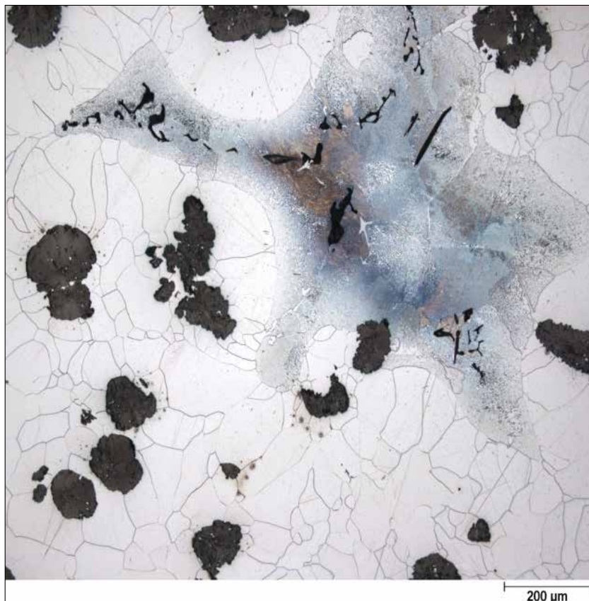
Bild 2: Endogene MgO-Einschlüsse in Gusseisen mit Kugelgraphit.
