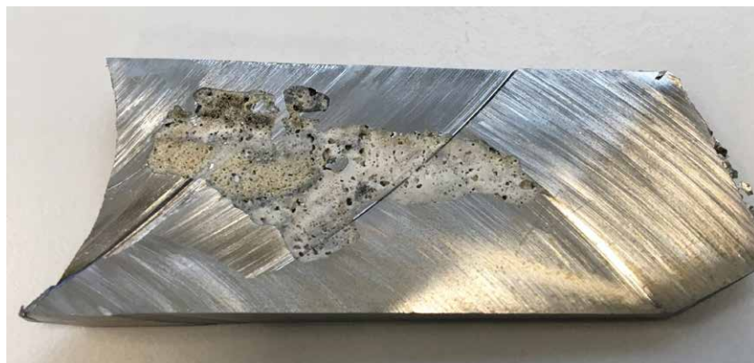
Bild 1: Exogener nichtmetallischer Einschluss in Stahlguss.
